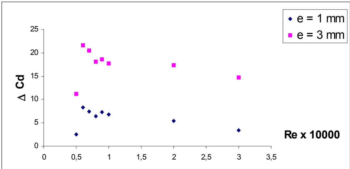
Figure 5 – 41 : La variation d’erreur sur le coefficient du débit entre les valeurs avec et sans dépôt de matière en amont pour un diaphragme à un  $\beta = 0,4$ .
